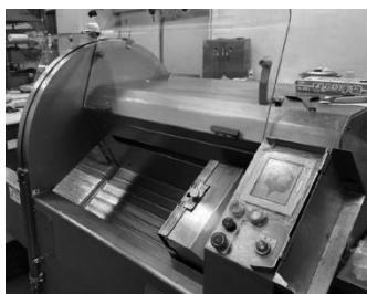
1mm単位で厚みを調整できる高速冷凍スライサー
