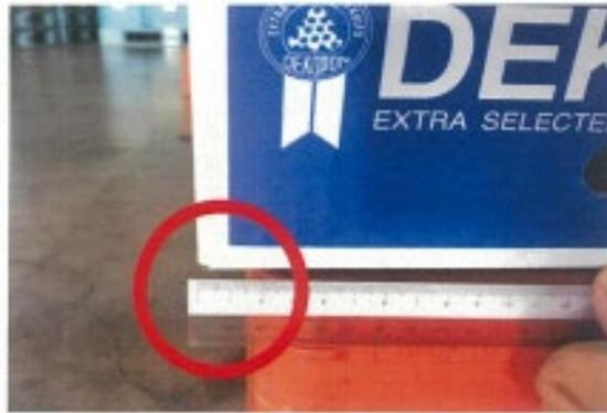
R5年度農産物・食品の物流標準化委託事業で、既存5kg段ボール積み付け時のオーバーハング（パレットサイズ超過）を確認。
