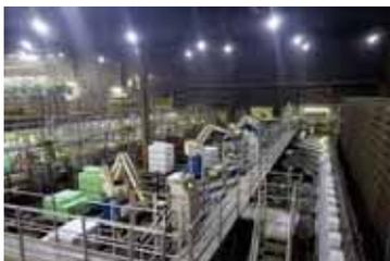
パレタイズロボット導入によるダンボール積みの自動化
